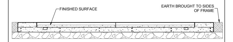
NOTE: FOR ARTIFICIAL TRACK SURFACES, THE DISTANCE THE CONCRETE IS FINISHED BELOW THE TOP OF THE CIRCLE SHOULD MATCH THE THICKNESS OF THE SURFACE TO BE INSTALLED.
