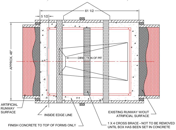
RECOMMEND A MINIMUM OF 4" OF CONCRETE AROUND THE SOFT BOX OUTER SHELL. CARE MUST BE TAKEN TO INSURE BOX IS LEVEL IN BOTH DIRECTIONS.
